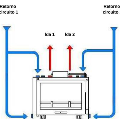
2 - Circuito hidráulico para Aquecimento Central e águas quentes sanitárias com válvula 3 vias.
